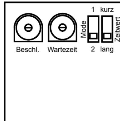
El tiempo de permanencia en la estación se configura mediante el interruptor „Pausa“ y el regulador de ajuste „Tiempo de espera“ de la platina.
