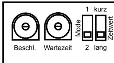
Le temps d'arrêt en gare est défini sur la platine via le commutateur «Pause» et le bouton de réglage «Temps d'attente».
